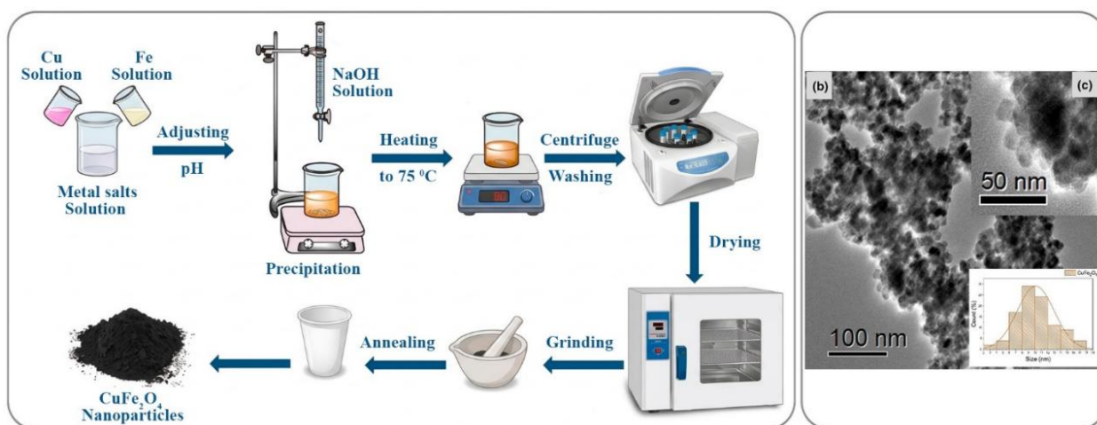
Рис.1.2. Схематичне зображення синтезу методом співосадження для наночастинок \text{CuFe}_2\text{O}_4 (зліва) та ТЕМ-зображення, що ілюструє морфологію частинок \text{CuFe}_2\text{O}_4 (справа). Адаптовано з [41].
