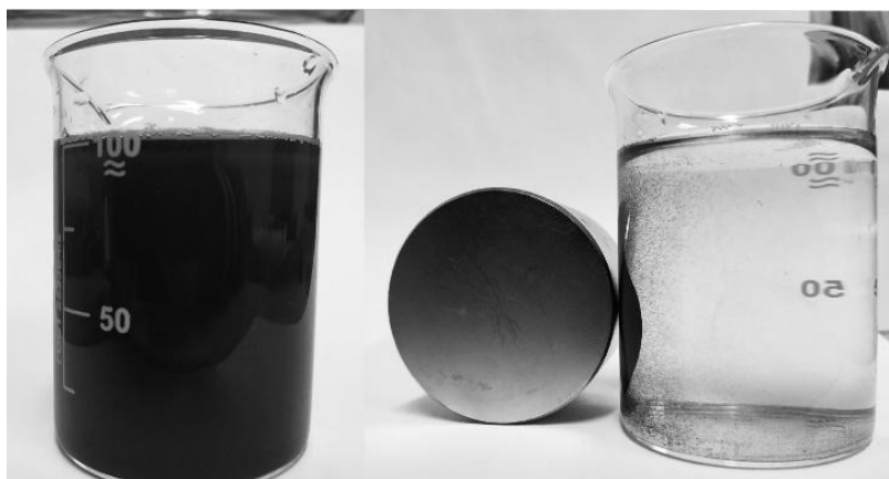
Рис.2.3. Магнітне видалення каталізатора, фотографія мідного фериту у водному розчині під дією зовнішнього магнітного поля, яке забезпечує його швидке відділення від рідини.
